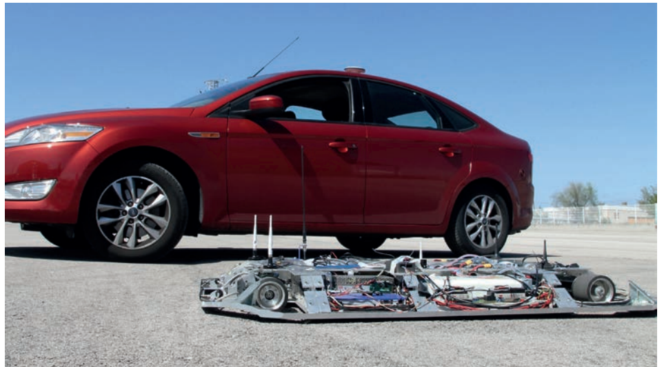
Abb. 1: AVATARES-Fahrplattform neben einem Testfahrzeug.
